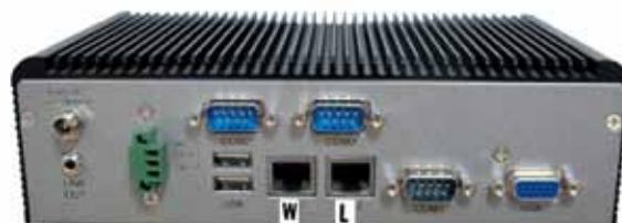
Figur 2. Hjärnan i Kabonas styrsystemet är hårdvaran WDC som styrs av den tillhörande mjukvaran Ecopilot. För att utnyttja byggnadens värmedynamiska egenskaper kopplas systemet samman med rumsgivare i varje temperaturzon.
