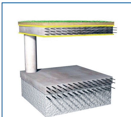
Överskottsvarme och kyla kan lagras i värmetröga byggnadsdelar, till exempel i ett parkeringsgarage. Där kan lämpligen taket isoleras och användas för värmelagring medan golvet utnyttjas för antingen kyla eller värme.
